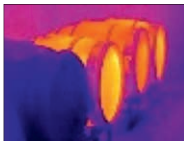
Mur pierre 50cm semi enterré : Exemple de remontées capillaires visible par imagerie infrarouge.
